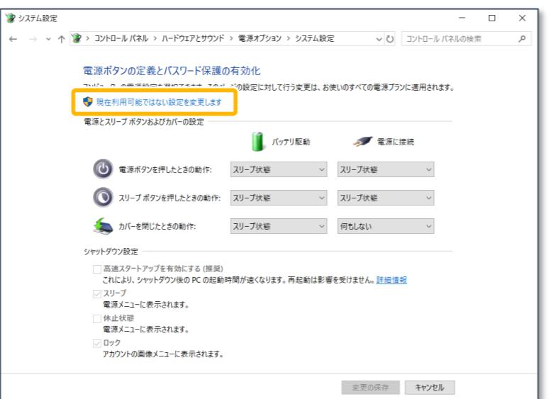
8 シャットダウン設定にある**高速スタートアップを有効にする（推奨）**をクリックし、チェックを外します。
